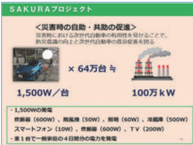
こちらは外部給電の有効性を数字的に説明した資料です。1台1,500Wの電気を出せるので、1年前の実績ですが、トヨタさんが国内で販売されたハイブリッド車64万台に単純に掛け算すると、100万kWです。発電所1基分の非常用電源が分散型で確保できることとなります。車を買うときは、外部
