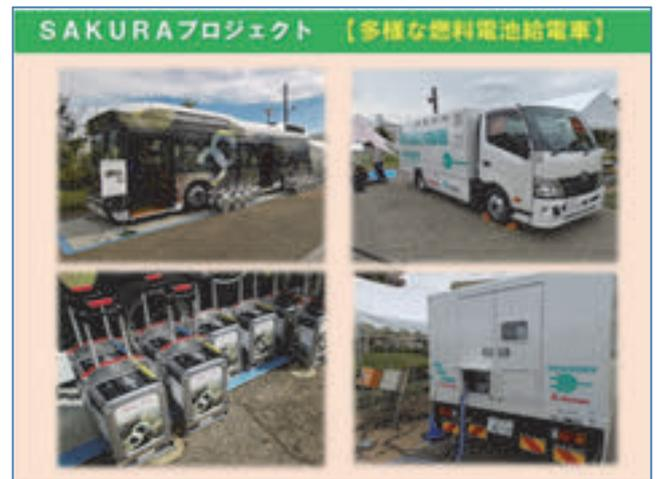
こちらは多様な外部給電車です。右のトラックは出力9kWです。左の燃料電池バスとカート型蓄電池は災害時に電気を届ける仕組みで、ホンダさんとトヨタさんのコラボ企画です。電気が必要なところに燃料電池バスが駆け付け、発電した電気をためたカート型蓄電池をばらまいて、電気を供給します。
