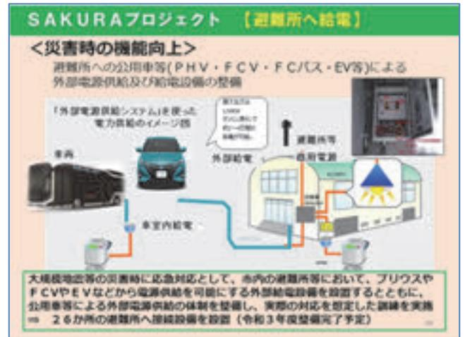
豊田市では、災害時に使えるように、市内の避難所26か所に順次、車とつなげられるような改造を行っていきまして、令和3年度に整備完了予定です。停電になっても、車が駆け付ければ、電気が確保できます。
